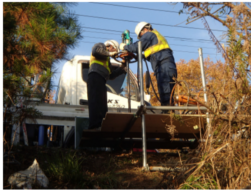
写真-3.4.6 パイプロハンマーによる簡易サンプリング実施状況
