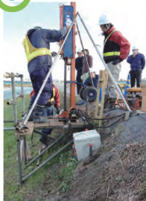
打ち込み用ロッドを打撃貫入し、先端コーンと有孔部のみを露出
