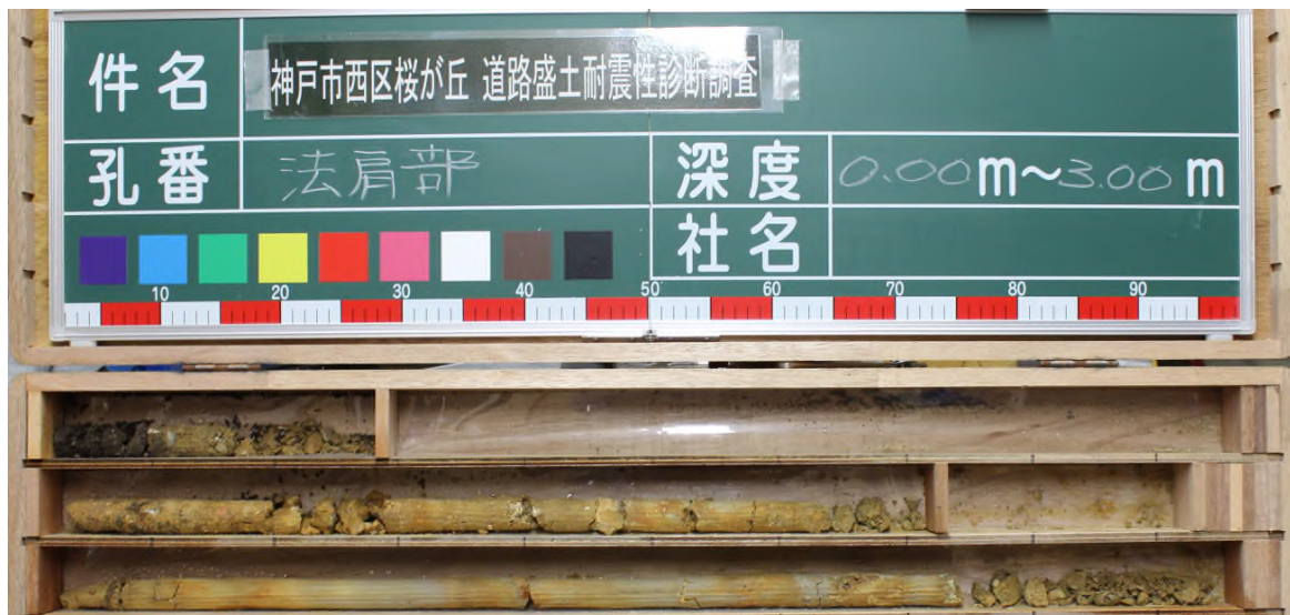
写真-3.4.6 パイプロハンマーによる簡易サンプリング実施状況
