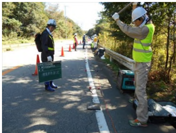
写真-3. 4. 5 表面波探査実施状況（測線 1）
