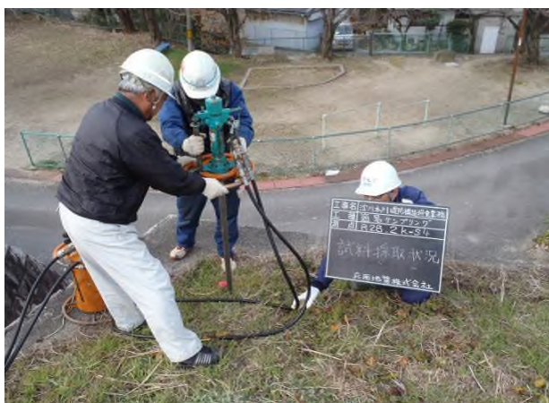
写真-3.2.2 土壌サンプリング作業状況
