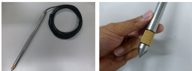
写真-3. 2. 5 小型間隙水圧計の仕様
