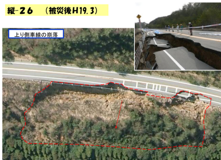
写真-3.1.1(f) 能登有料道路地震被害状況写真 (15.9kp、縦-26)
