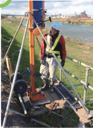
仮設足場の設置および簡易打撃装置（オートマチックラムサ운드）の設置
