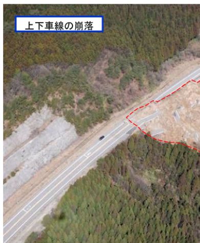
写真-3.1.1(h) 能登有料道路地震被害状況写真 (21.1kp、縦-38)
